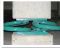
地下に600か所以上設置されているダンパー
